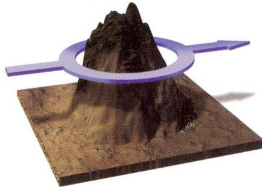
Figura 3.18. Comportamiento del viento en montañas aisladas.
