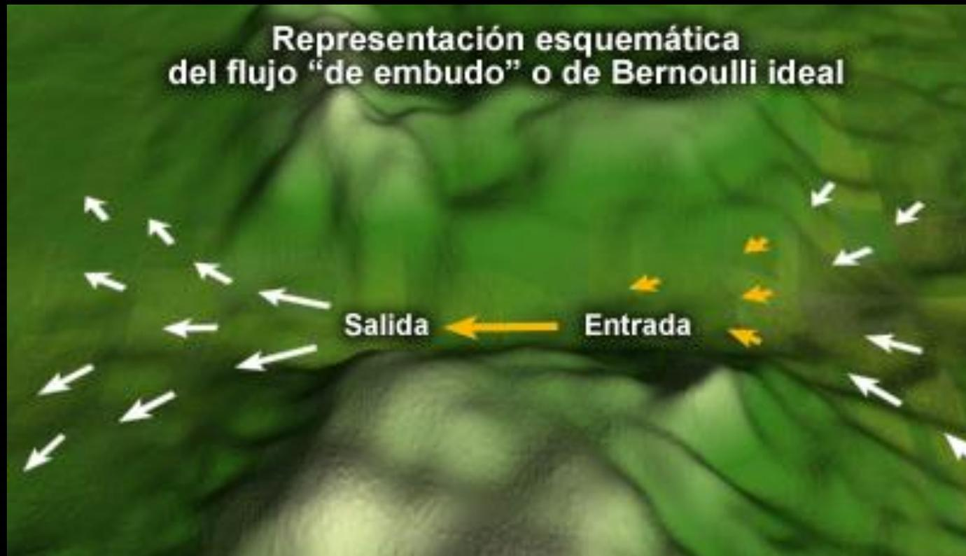
Aunque físicamente es plausible, **el mecanismo de Venturi no parece coincidir con la mayoría de las situaciones reales de viento canalizado**, en las cuales los vientos más intensos suelen producirse en la región de salida de la canalización, y no en la sección más angosta del estrangulamiento
