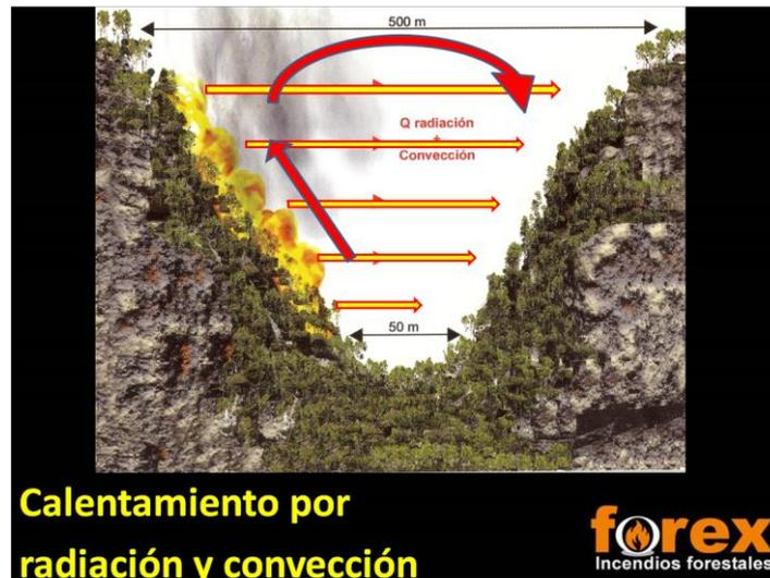
Ilustración 21. Efecto conjunto radiación-convección (1).
